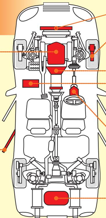
**冷却装置** ウォーターポンプ 水温センサー 電動ファン ファンブリー 放射ター本体
